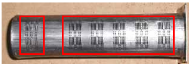
Bruciatore per modello Classic 5000 e 7000 . Tale rampa presenta sei gruppi di fessure, cinque in serie ed una in cima alla rampa gas.
